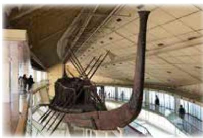
ギザのピラミッドの横で発見された、紀元前2500年頃に作られた、全長約42mの「太陽の船」。この世界最古の大型木造船は、レバノンから輸入された杉を使い、1本の釘も使わずに作られました。
